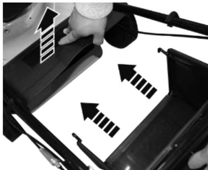
**c. Fijación de la altura de corte**
